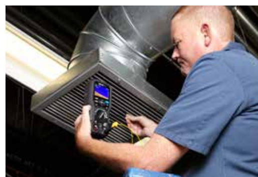
Entrada de termopar de tipo K para mediciones de temperatura diferencial
