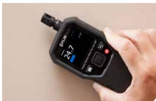
Verifique la humedad con mediciones sin clavija
